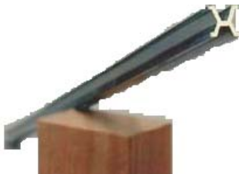
Barra de hierro que representa un metro (Oficina de pesos y Medidas de Lèvres)
